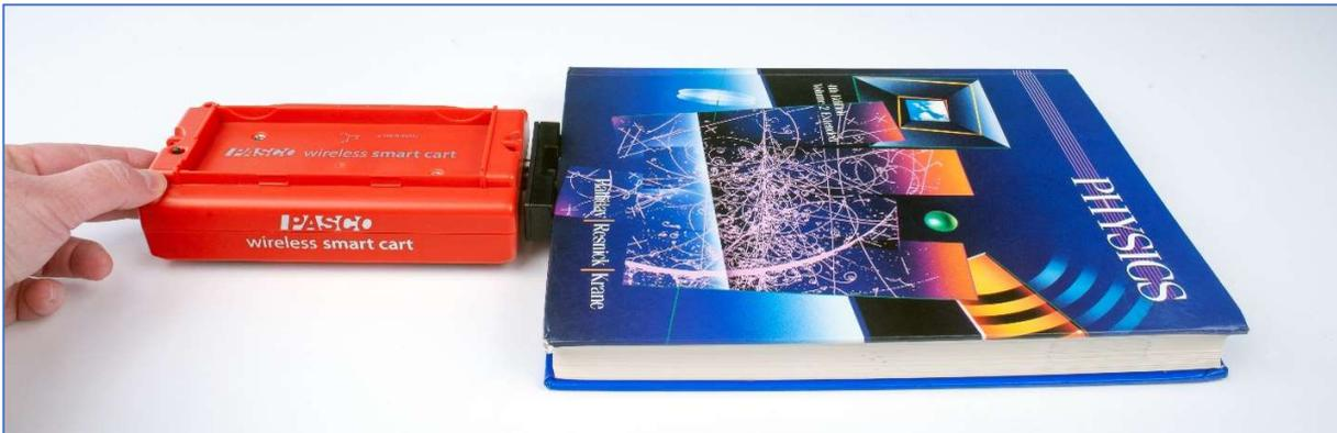
Dans cette expérience nous utiliserons une Smart Cart équipée d'un capteur de force (sur le pare-chocs), qui pourra mesurer force et position, et un livre.
